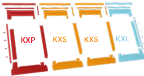
Połączenie czterech okien dachowych w poziomie (X)
